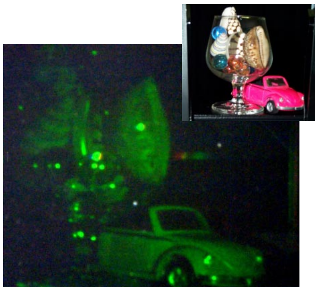
図6 リップマンホログラムの再生像 グラスに入れた貝殻とミニカー(右上が普通の写真)
