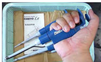
図 4-3 ピペッティングは親指で操作する
