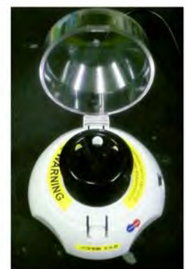
図3-2 小型遠心機 1.5 mlチューブ用
