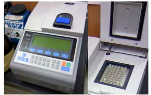
図3-5 PCR装置とそのヒートブロック部分
