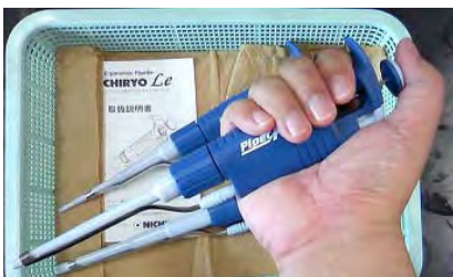
図 4-3 ピペッティングは親指で操作する
