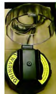
図3-4 8連式 PCR チューブ用遠心機
