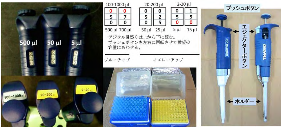
図 4-1 ピペットマンの目盛りと使用するチップ、ピペットマンの各部名称
